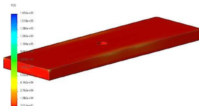
Gambar 23. Analisis faktor keamanan ( safety factor ) dudukan mesin centrifugal casting .
