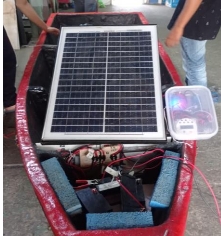
Gambar 1 Penempatan Pengujian Solar Cell di atas perahu
